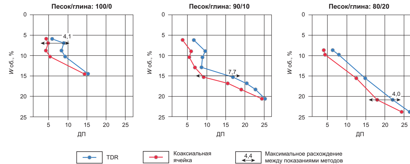
Рис. 5. Графики зависимости ДП от весовой влажности для природных песчано-глинистых смесей различного соотношения по двум методам измерения
