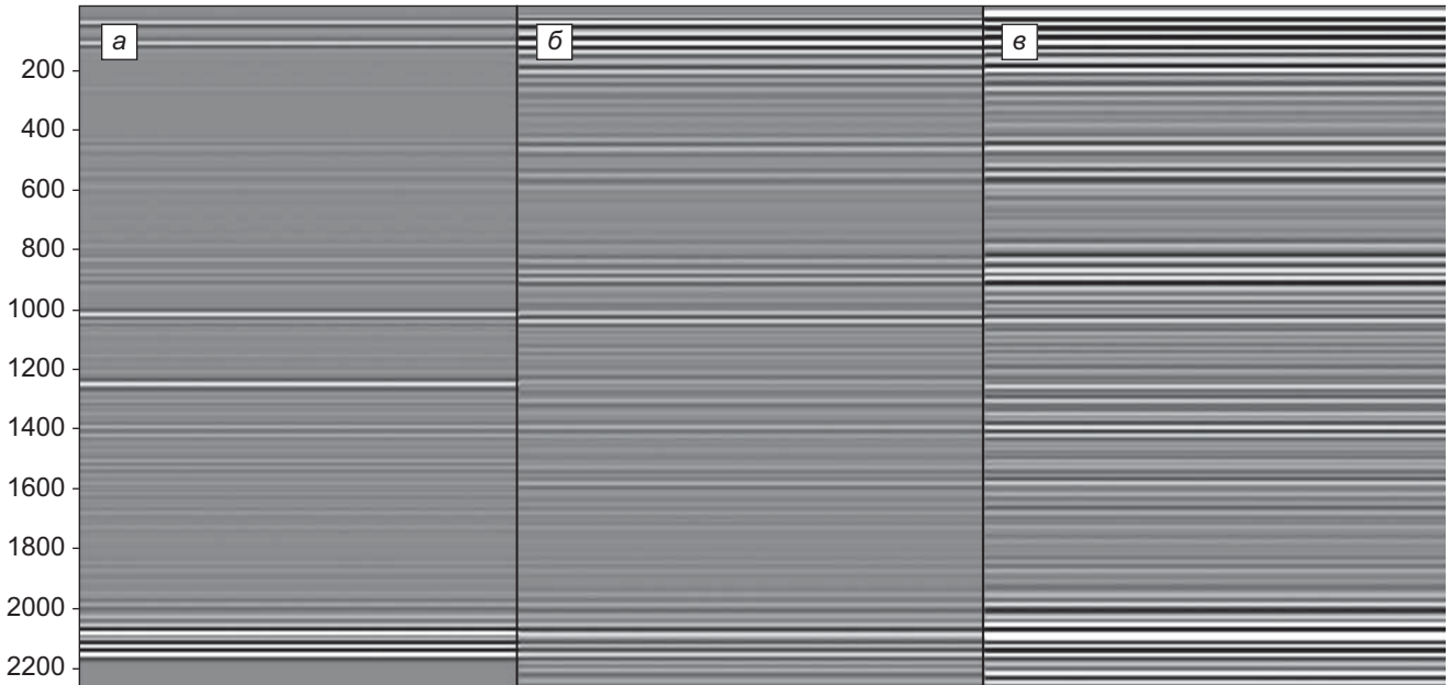
Рис. 5. Разрезы, полученные по свертке (а), акустическому моделированию (б) и полноволновому моделированию (в) для модели среды из опорной скважины.
