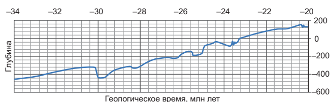
Рис. 5. Кривая палеоглубин Северо-Чукотского бассейна, использованная для моделирования
