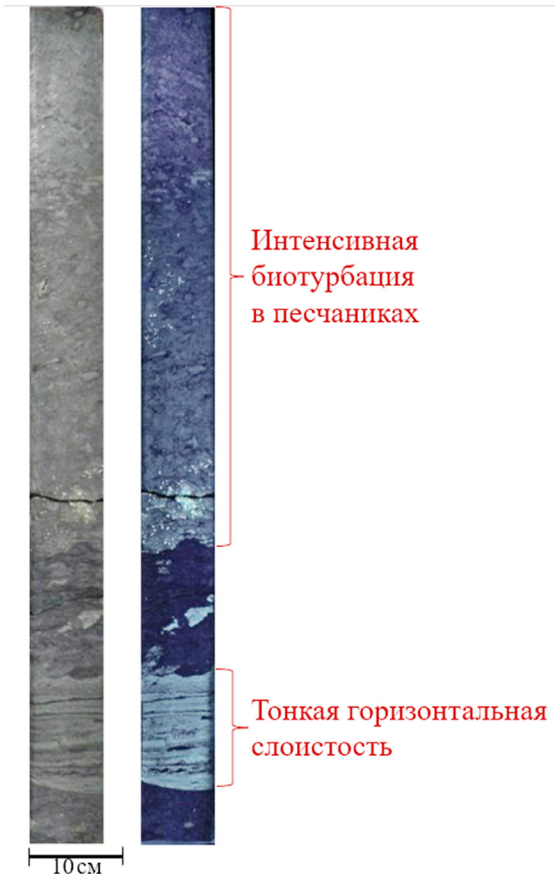
Рис. 1. Геолого-геофизическая характеристика альбских отложений одного из месторождений Северного Каспия
