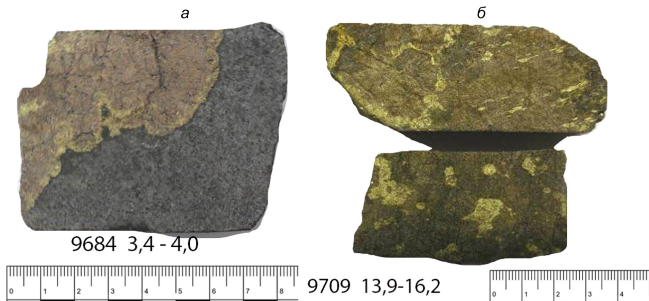
Рис. 5. Кайма халькопирита на границе кристалла пирротина и включения габбро-долерита (а); петельчатый и пластинчатый халькопирит в пирротине, скв. Т9709 (б)
