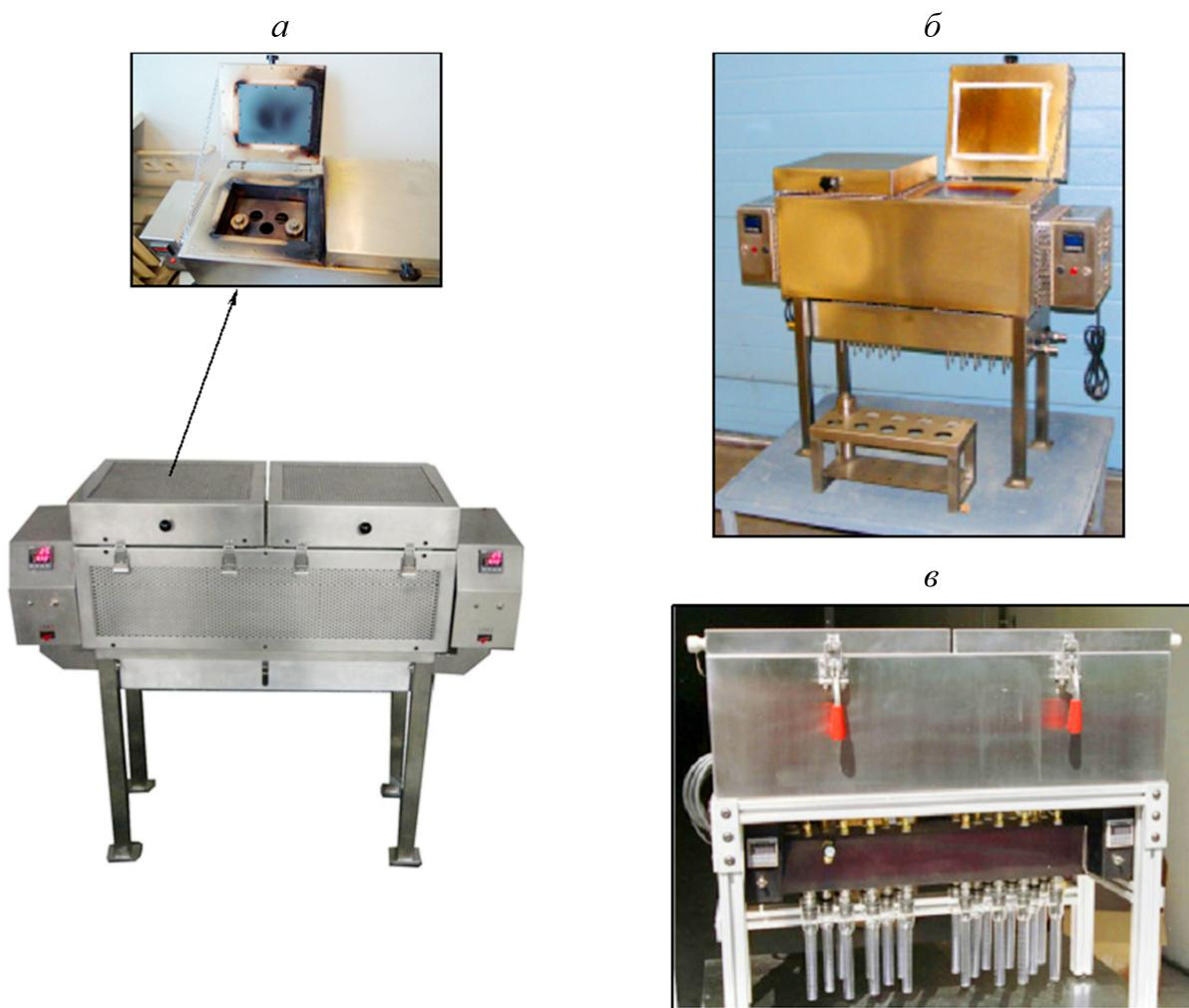
Рис. 4. Фото некоторых промышленных установок реторты: а — ретортная печь VICI Technologies масса 50 кг, размер 104×88×32 см, нагрев до 650 °C (фото из <https://www.vinci-technologies.com/products-explo.aspx?IDR=82292&idr2=82545&IDM=601152>); б — ретортная установка Seba HOCS1, размер 142×71×33 см (фото из <https://www.seba.co.uk/products/retort-ovens/>); в — ретортная установка по [McPhee, Reed, Zubizarreta, 2015]
