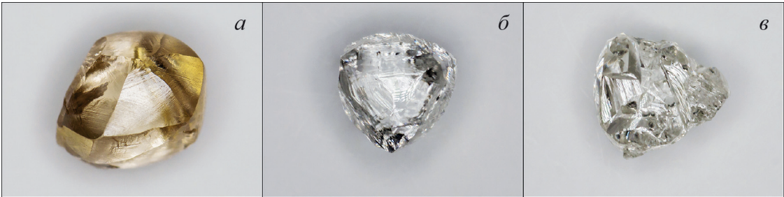
Рис. 3. Фото некоторых исследованных алмазов из россыпи Эбелях: а — обр. Эб-77-2, коричневый додекаэдроид уральского типа с шагреновой поверхностью и полосами пластической деформации, с износом 2-й степени, группа А; б — обр. Эб-39-9, кривогранный шпинелевый двойник, представленный додекаэдроидом уральского типа, без износа, группа Б; в — обр. Эб-38-3, кривогранный сросток с многочисленными двойниковыми швами и слабым износом, наибольший кристалл в сростке имеет додекаэдрический габитус, с реликтами сноповидной штриховки, группа В. Фото алмазов приведены в одном масштабе, поля зрения 7×5,2 мм
