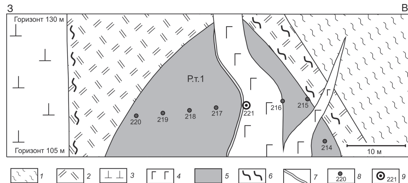
Рис. 4. Профиль через рудное тело 1 и поздние габбро-порфиры: 1 — метасоматиты; 2 — дайиты; 3 — габбро-порфиры (предрудные); 4 — габбро-порфиры (позднерудные); 5 — колчеданно-полиметаллические руды; 6 — зоны рассланцевания; 7 — кварц-карбонат-сульфидные жилы; 8 — точки отбора проб; 9 — пробы, участвовавшие в эксперименте
