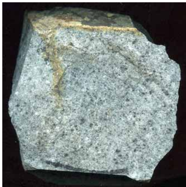
Рис. 3. Мелко-среднезернистые плагиограниты с вкрапленниками фаялита. В верхней части образца плагиограниты замещены околотрещинными березитами, 108×109 мм. Юго-запад южного склона г. Кастель
