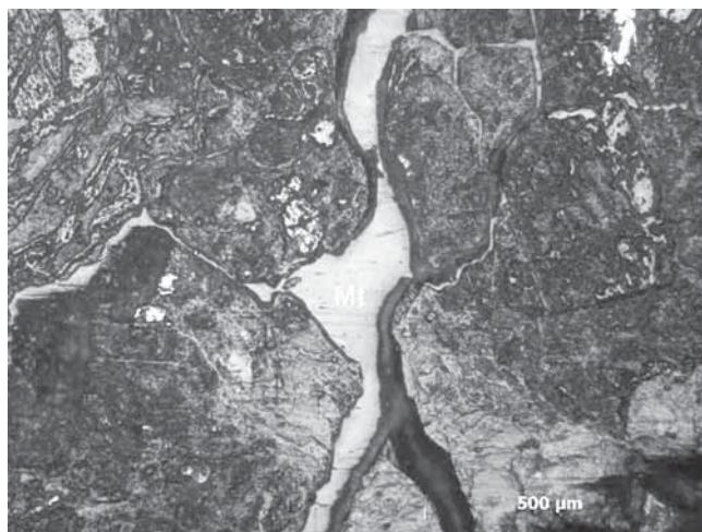
Рис. 2. Прожилок магнетита (Mt) в нерудном веществе (никили параллельны)
