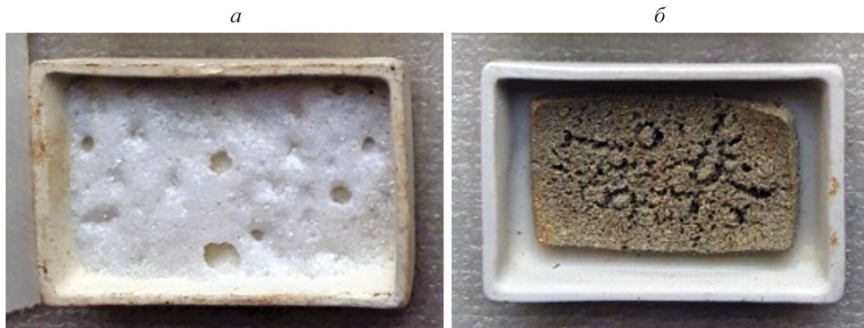
Рис. 3. Фото продуктов опытов первой серии экспериментов: а — образец на основе состава 1, T=1000\text{ }^{\circ}\text{C} ; б — образец на основе состава 2, T=1000\text{ }^{\circ}\text{C} . Приблизительный размер полученных образцов составляет 2\times 4\text{ см}
