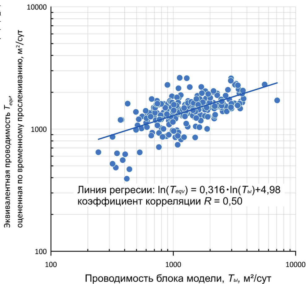
Рис. 7. Связь между эквивалентной проводимостью, оцененной методом временного прослеживания, и значением поля проводимости в точке опробований. R=0,50
