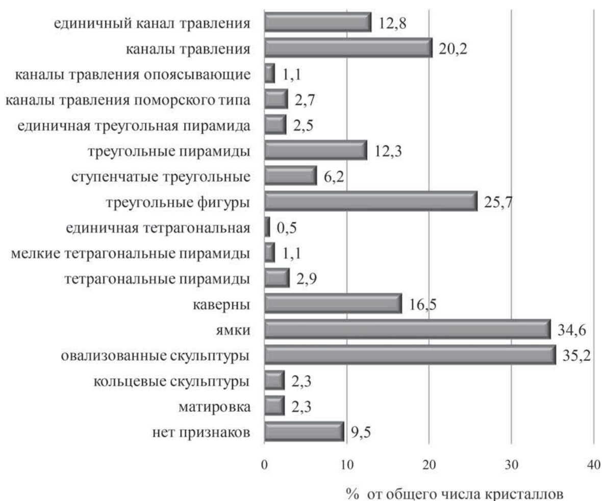
Рис. 7. Частота встречаемости различных типов акцессорного травления поверхности кристаллов алмаза из трубки Заполярная. Сумма разных типов превышает 100%, так как на одном кристалле может быть проявлено несколько из них. Под пирамидами и треугольными фигурами подразумеваются отрицательные формы
