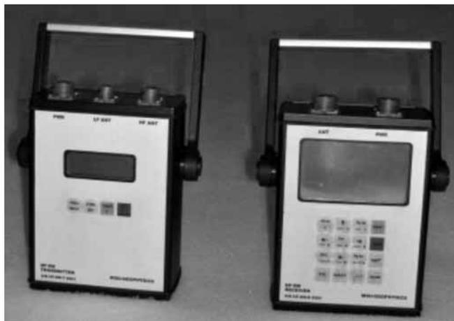
Рис. 15. Комплект аппаратуры HF-EM (слева — генератор, справа — измеритель)
