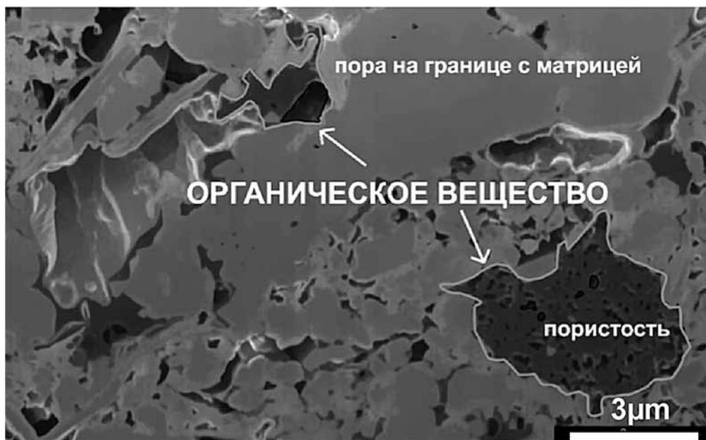
Рис. 12. FIB-SEM изображение образца породы баженовской свиты
