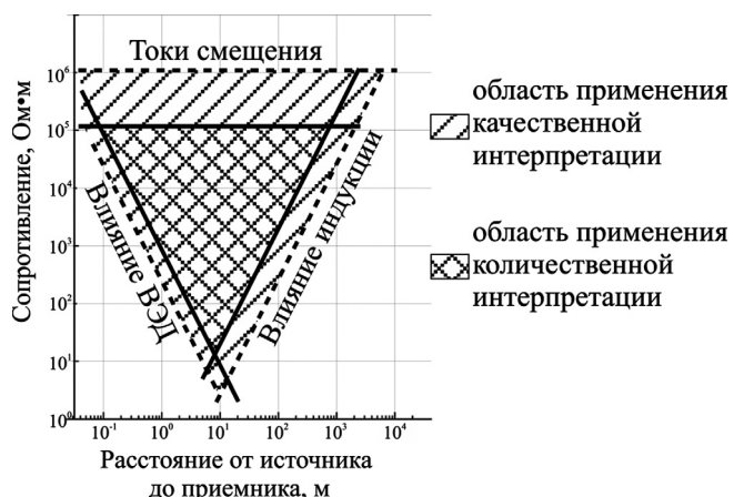
Рис. 7. Область применения бесконтактной технологии метода сопротивления для частоты 16 600 Гц
