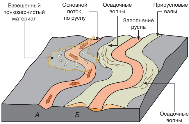
Рис. 5. Схема формирования осадочных волн, связанных с прирусловыми валами глубоководных канальных систем (по [Posamentier, Walker, 2006] с изменениями). а — движение потока с «облаком» взвешенных частиц по руслу; б — сформировавшиеся прирусловые валы, осложненные осадочными волнами
