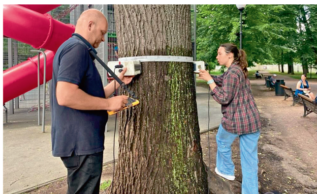
Рис. 5. Процесс работы с антеннами 1500 МГц (слева) и 2000 МГц (справа)
