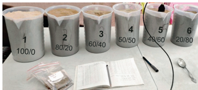
Рис. 1. Подготовленные сухие песчано-глинистые смеси в процессе измерения методом TDR ДП смеси в емкости № 5 (с указанием номеров и процентных соотношений в них песка/глины)
