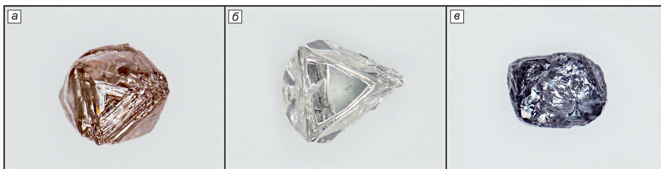
Рис. 2. Примеры исследованных алмазов россыпи Хара-Мас: а — обр. ХарАК-10-1: коричневый кристалл переходной формы октаэдр — додекаэдр, с расщеплением вершин, параллельной и сноповидной штриховками, каналом травления, расщеплением вершин и линиями скольжения, группа «А»; б — обр. ХарАК-1-1: октаэдрический шпинелевый двойник слабого желтого оттенка, со сноповидной штриховкой, ямками травления и единичным включением графита, группа «Б»; в — обр. ХарАК-2-11: серый комбинационного строения октаэдр — додекаэдр V разновидности по классификации Ю.Л. Орлова, с глубокими каналами, кавернами и треугольными фигурами травления, блочным строением и многочисленными включениями графита, группа «В». Фотографии алмазов в приведены в одном масштабе, поля зрения 7 \times 5,2 мм
