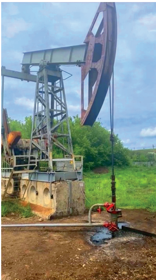
Рис. 2. Утечка пластового флюида из-за изношенности устьевых сальников (СУСГ) на одном из месторождений Татарской НГО
