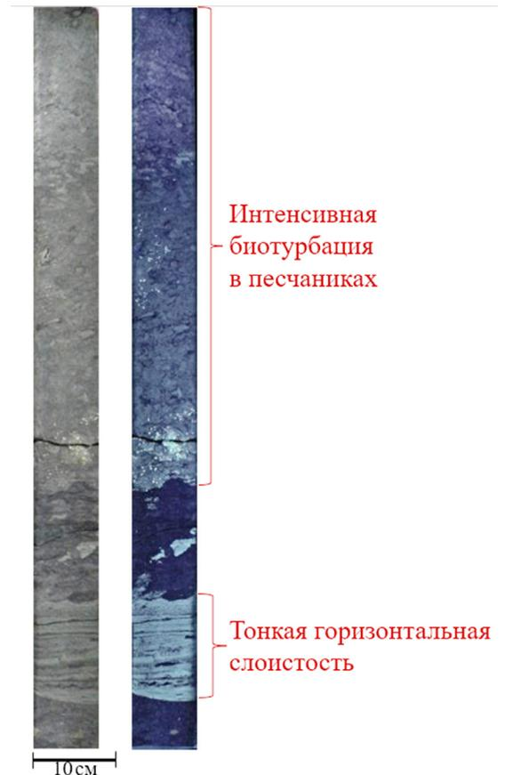
Рис. 2. Фотографии керна (интервал — коллектор): слева — при дневном свете, справа — в ультрафиолетовом свечении. Глубины 1436,7–1437,7 м
