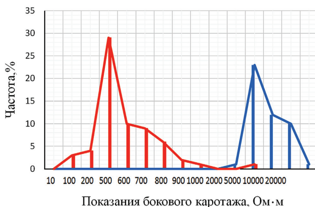
Рис. 11. Пример определения граничного значения удельного электрического сопротивления для разделения пород, содержащих легкие углеводороды, и пород с неподвижными углеводородами (смолисто-асфальтеновые вещества). Оранжевым показаны пропластки доманикового типа с подвижными углеводородами, синим — плотные пропластки с содержанием неподвижных углеводородов (смолисто-асфальтеновые вещества)
