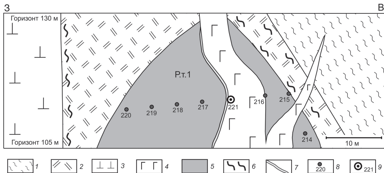
Рис. 4. Профиль через рудное тело 1 и поздние габбро-порфириды: 1 — метасоматиты; 2 — дациты; 3 — габбро-порфириды (предрудные); 4 — габбро-порфириды (позднерудные); 5 — колчеданно-полиметаллические руды; 6 — зоны расщеливания; 7 — кварц-карбонат-сульфидные жилы; 8 — точки отбора проб; 9 — пробы, участвовавшие в эксперименте
