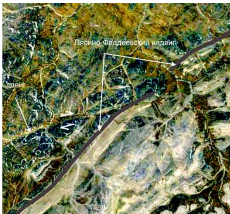
Рис. 5. Правый сдвиг в районе Пясино-Фаддеевского надвига (врезка Г на рис. 3). Космический снимок, Google maps
