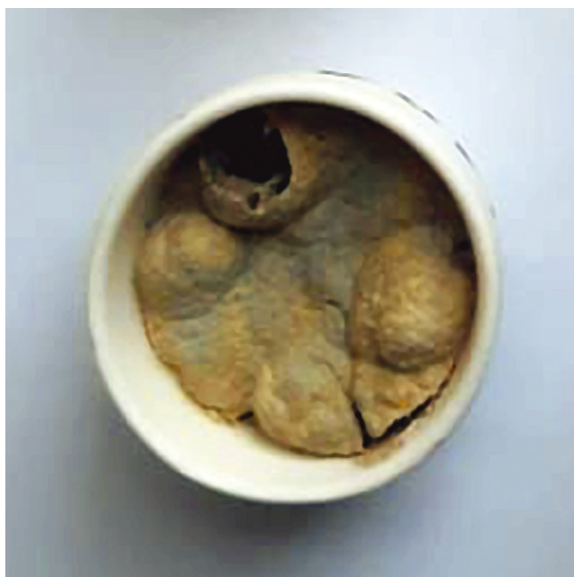
Рис. 7. Фото образца из шихты на основе опоки, полученного в третьей серии экспериментов; вспенивание. Приблизительный диаметр поверхности образца 2,5 см
