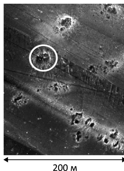
Рис. 5. Пример записи ГЛБО, полученной на Онежском полуострове. Белым кругом обведено положение одного из покмарков. Понижение в рельефе имеет изометрическую форму и радиус ~5 м
