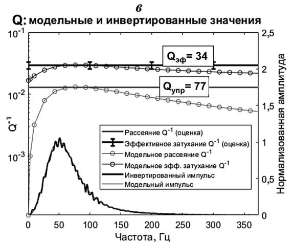
Акустическая модель слоистой среды (мощность слоя 1 м) (а); синтетическая трасса ВСП, методом отклонений показаны трассы, используемые для инверсии в интервале 600–800 м (б); модельные (сплошная линия) и рассчитанные значения параметров затухания (пунктир) в интервале (в)
