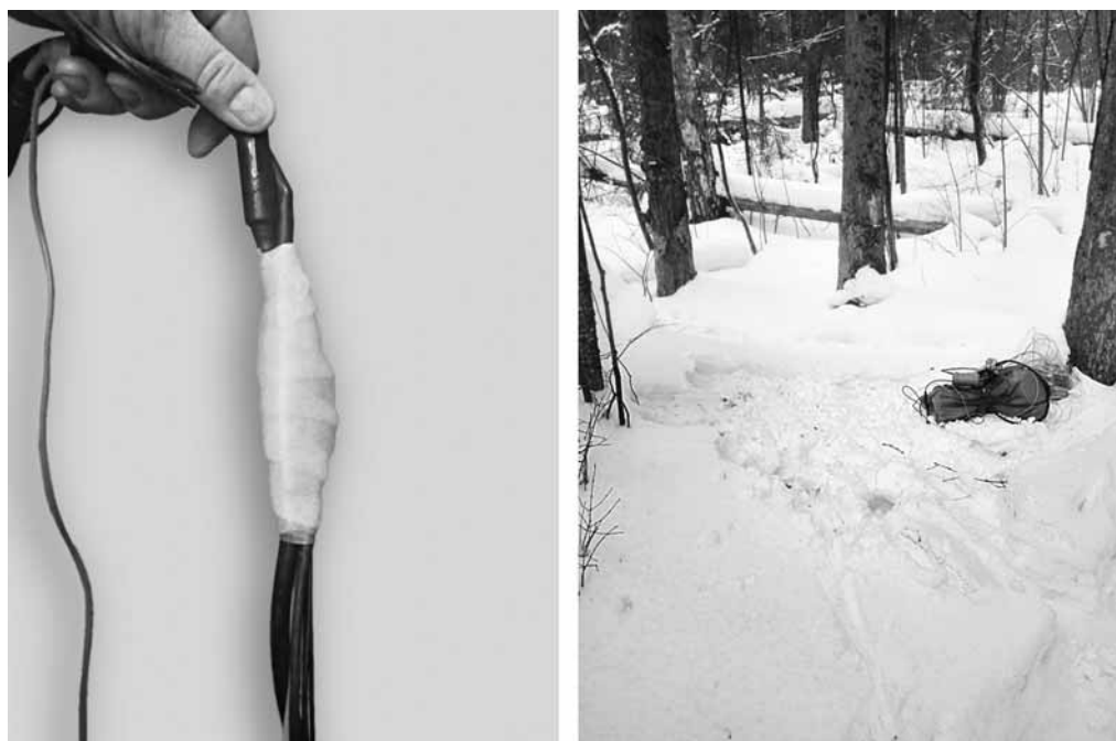
Рис. 1. Блок термодатчиков (слева) и площадка эксперимента (справа)
