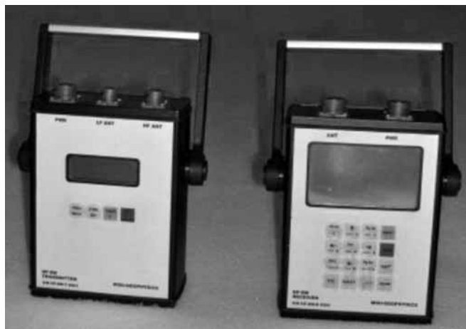
Рис. 15. Комплект аппаратуры HF-ЕМ (слева — генератор, справа — измеритель)
