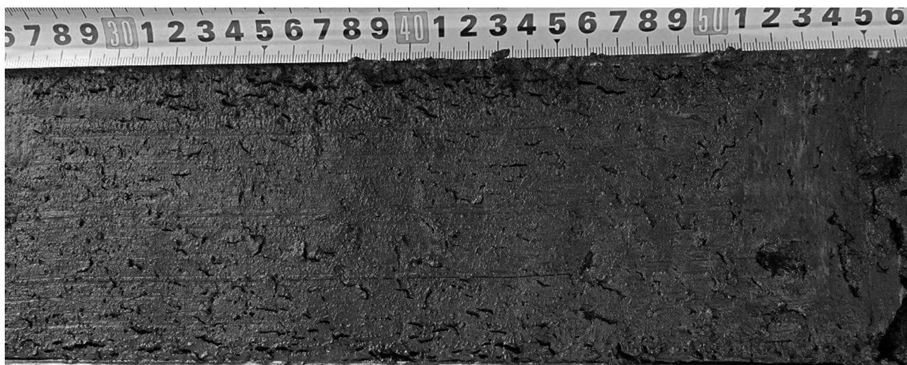
Рис. 4. Фрагмент керна (станция WS18-14G, глубина 230–250 см) с текстурами выхода газа
