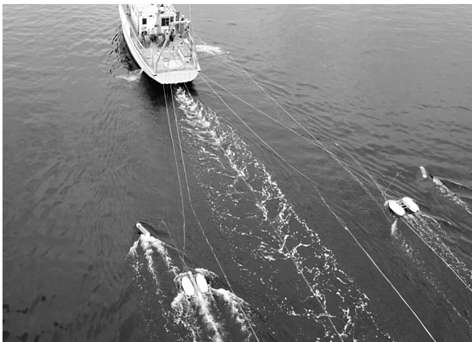
Рис. 1. Сейсмоакустические наблюдения с трехмерной (3D) системой на Белом море, НИС «Профессор Зенкевич»
