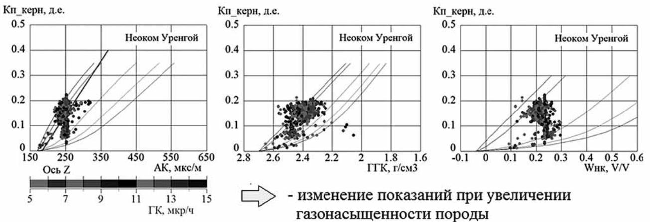
Рис. 3. Сопоставление данных, полученных методами АК, ГГК и НК и коэффициента пористости, определенной по керну
