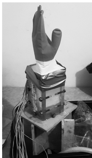
Рис. 1. Установка для исследования фильтрации газа сквозь мерзлые образцы при отрицательной температуре. Резиновая перчатка, надетая на контейнер, предназначена для фиксации выделения газа с поверхности образца. Фото П.А. Соболева
